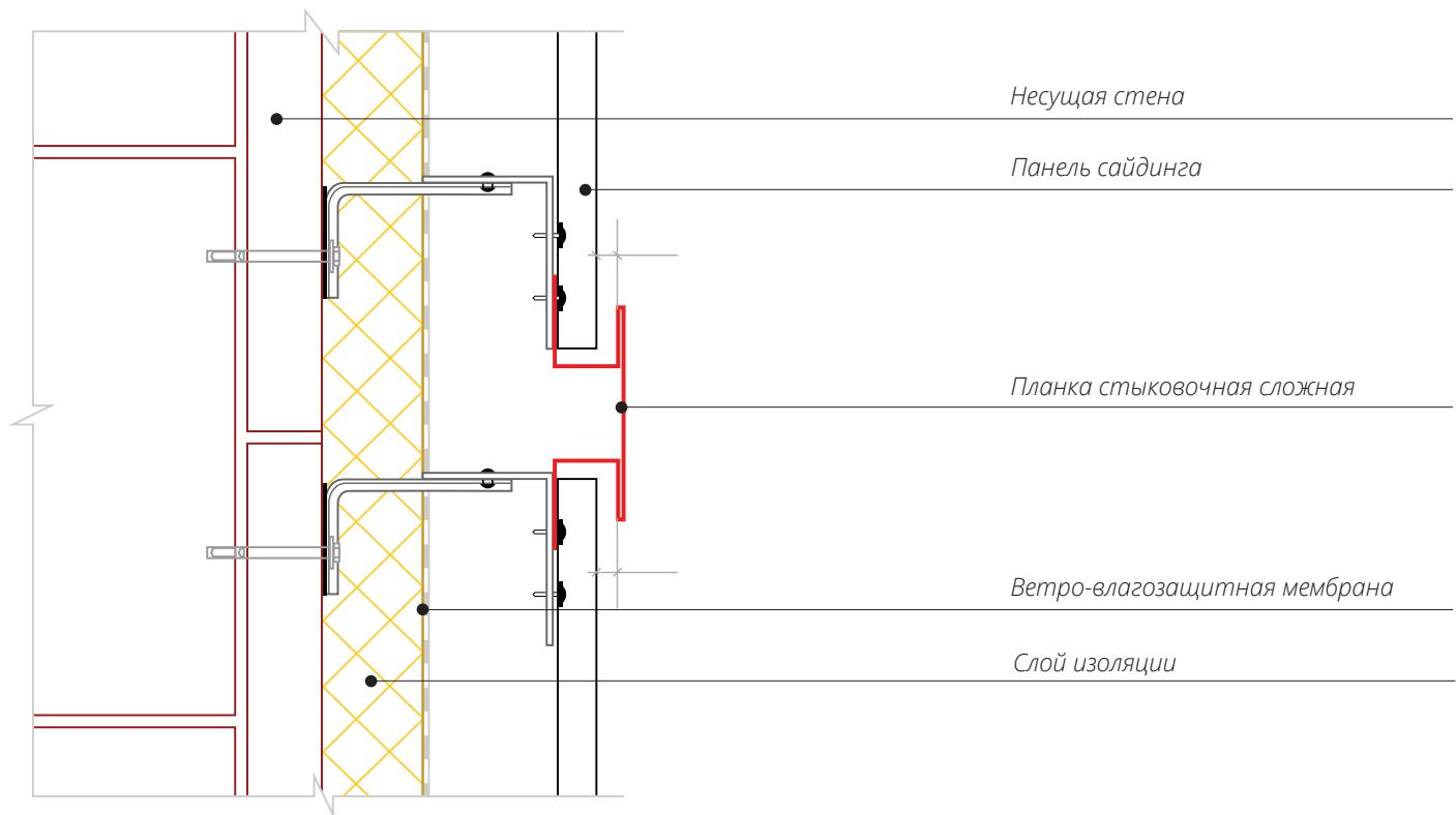
**Стыковочный узел простой. Вертикальный разрез.**
