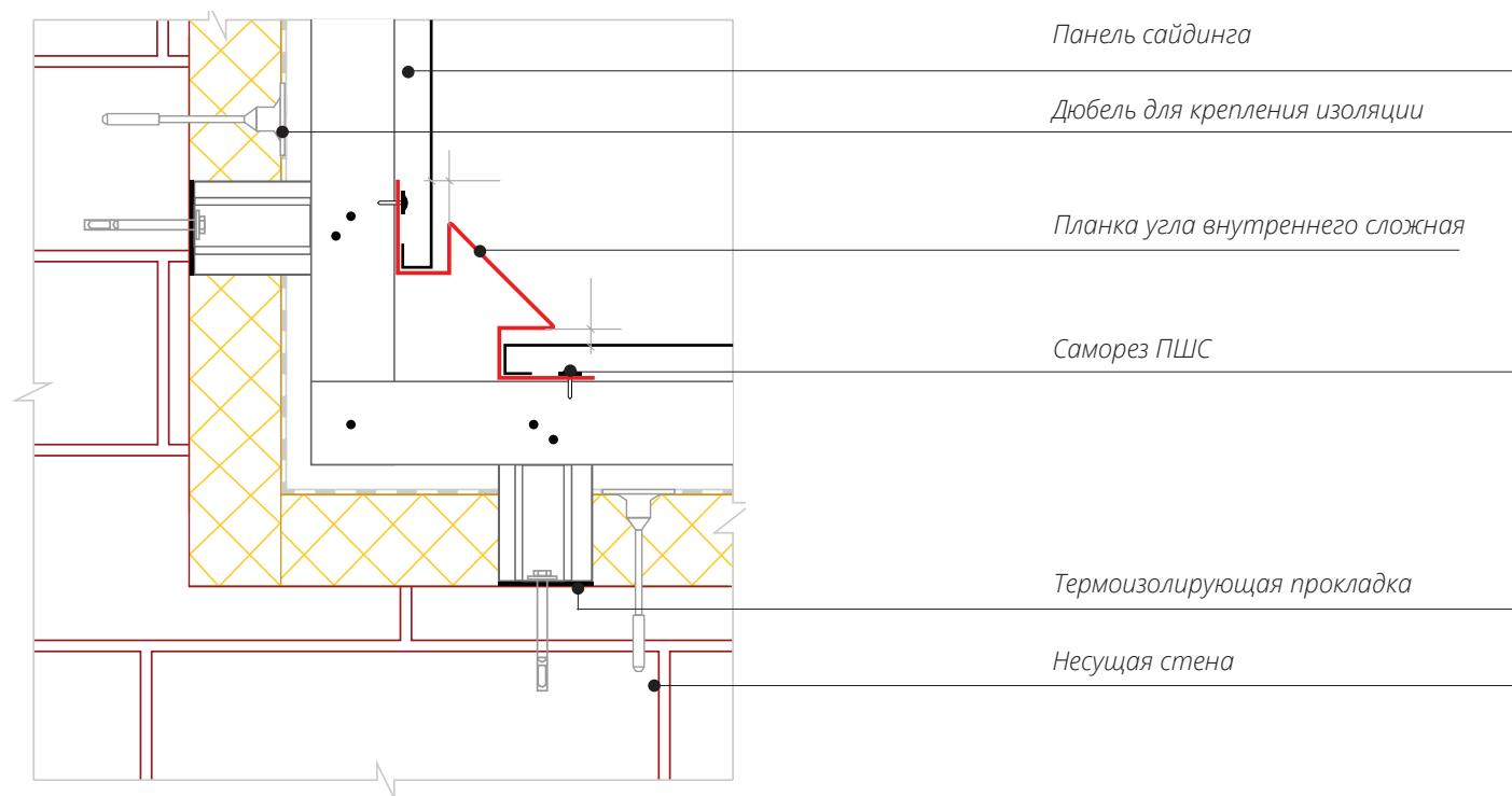
**Внутренний угол простой. Горизонтальный разрез.**
