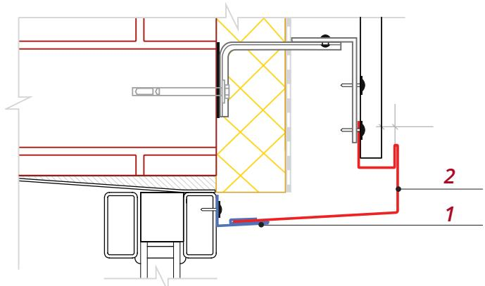
Рис. Верхний откос и отлив с Планкой приемной оконной
