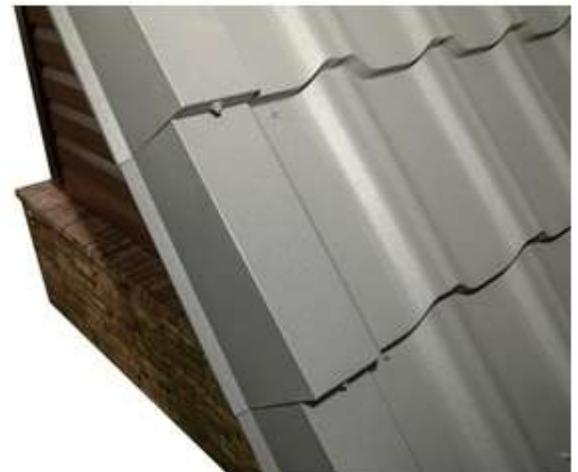
Сегментные торцевые планки устанавливаются после монтажа торцевых досок и листов металлочерепицы. Направление монтажа - снизу вверх, от карниза к коньку.
