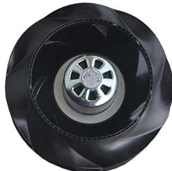
В оборудовании установлены надежные, высокоэффективные, вентиляторы Ebmpapst и Ziehl-Abegg. Электронно коммутируемые вентиляторы (EC) с управлением по линии 0...10в. EC-Вентиляторы регулируются в диапазоне от 20% до 100% с точностью в 1%, это позволяет максимально точно подвести воздухообмен к расчетным/проектным значениям. Приточный и вытяжной вентиляторы настраиваются раздельно, что позволяет балансировать приточную и вытяжную линии изменением настроек вентиляторов.
