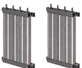
В оборудовании Zenit НЕСО 550 1.5/3.0E220 установлена две кассеты РТС нагревателя мощностью 1500 Ватт каждая. В коробке автоматики установлен автомат защиты включая и выключая который можно выбирать максимальную мощность нагревателя.
